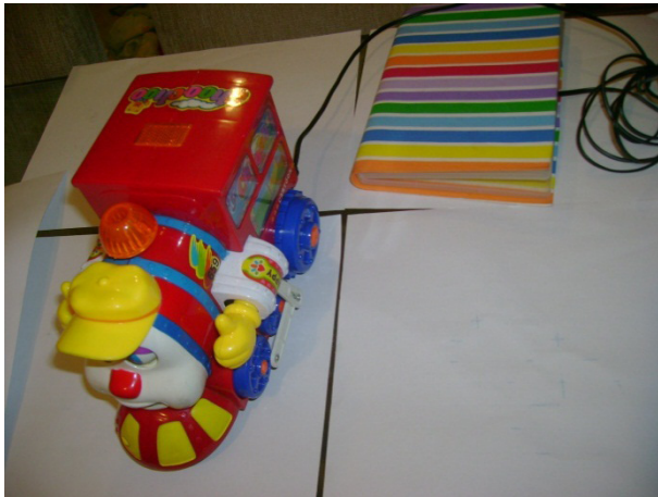
Figura 2 - Acionador de pressão acoplado ao brinquedo
