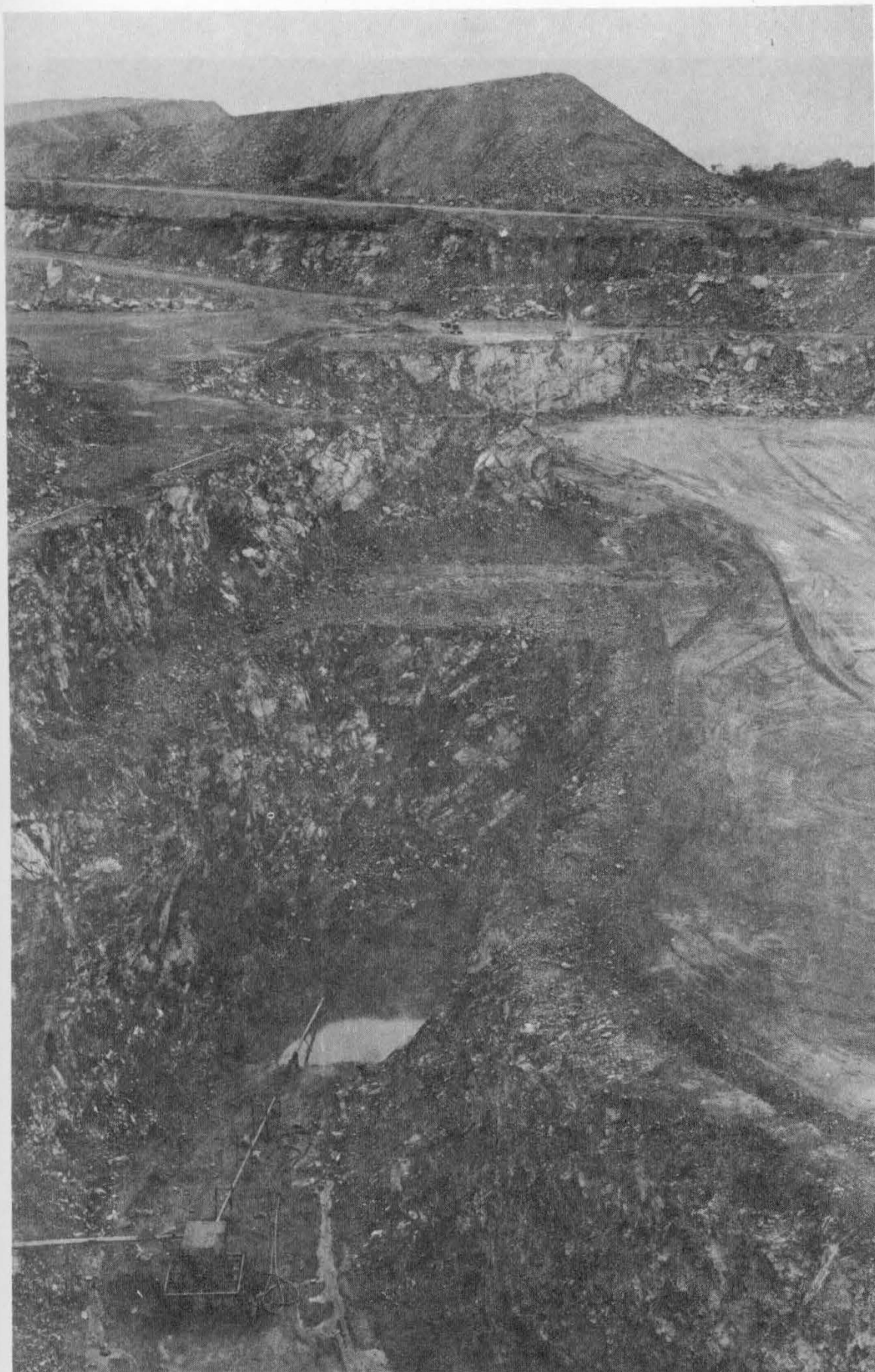
Foto nº 9 - Detalhe da Cava A, ilustrando o poço de coleta e bombeamento de água de infiltração e de chuva. As bombas estão fixadas sobre uma base flutuante de tambores vazios.
