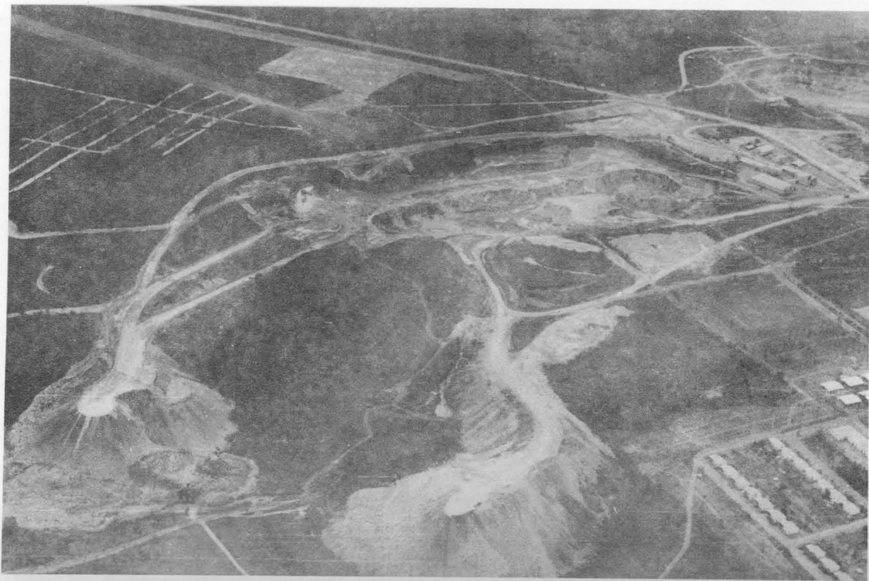
Foto nº 10 - Vista aérea da Cava B com duas bancas de rejeito, a da esquerda correspondendo ao decapeamento. No canto esquerdo superior, caminhos de acesso às sondas de pesquisa.
