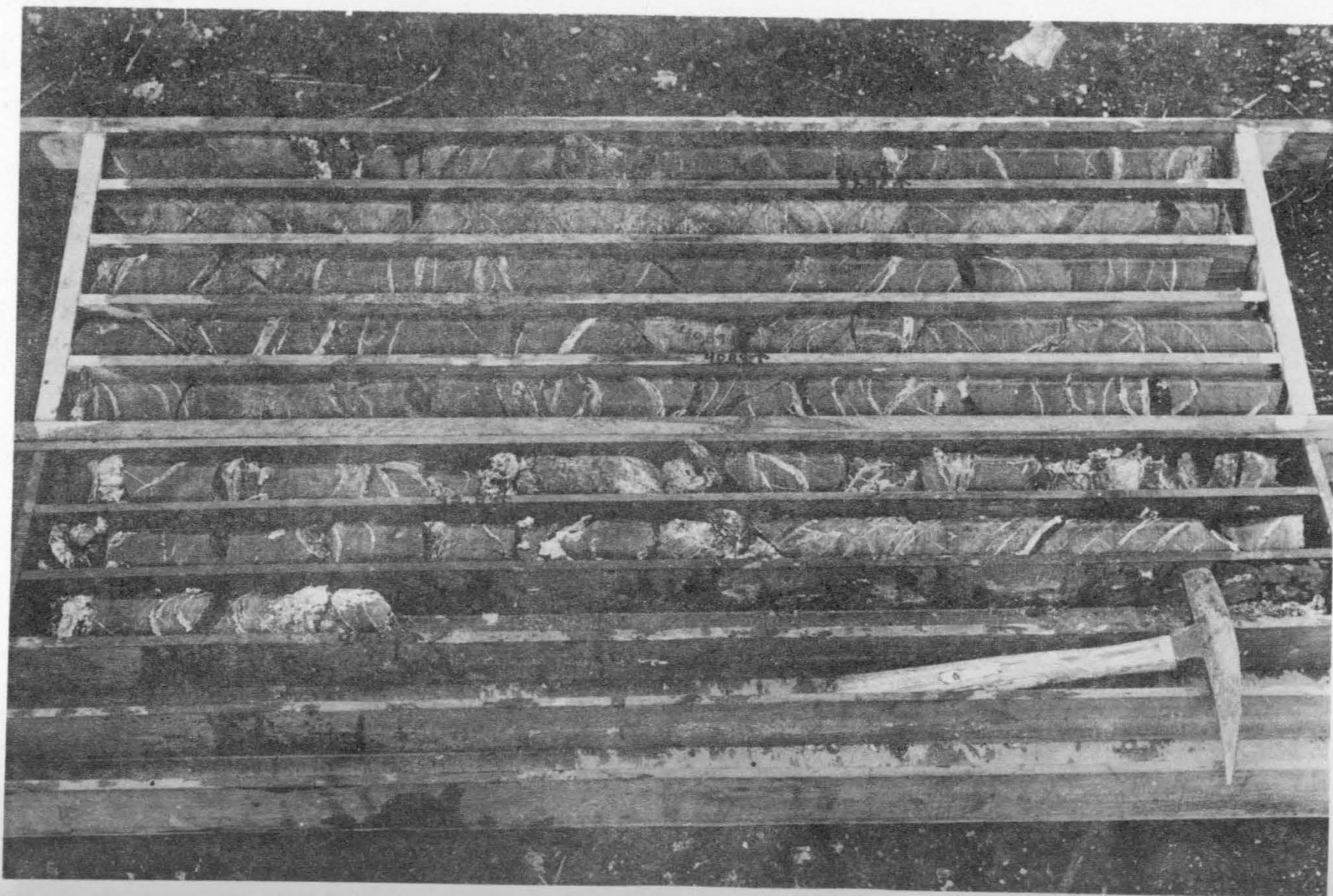
Foto nº 6 - Testemunho de sondagem de minério de Cana Brava, diâmetro - tro NX, mostrando recuperação muito boa em comprimento (cêrca de 95%) mais com alguma perda de fibra longa nos pontos de quebra do testemu
