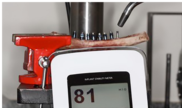
Figura 9 | Aparelho Osstell ISQ registrando o índice ISQ após instalação de implante.
