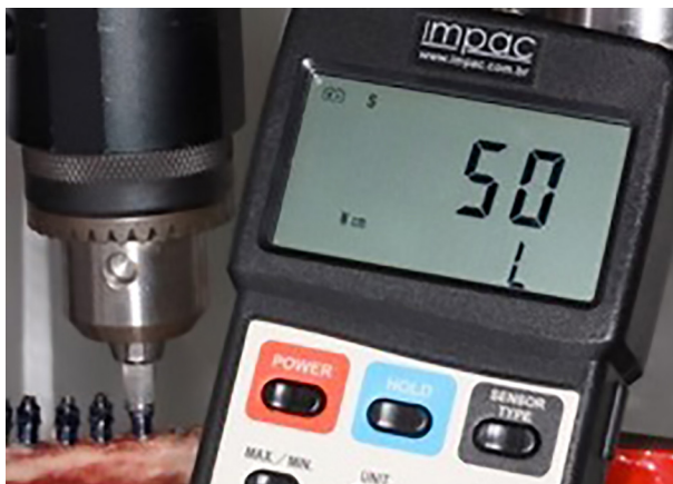
Figura 6 | Registro do valor do torque de inserção máximo obtido através do torquímetro digital.
