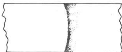
Figura 2 — Raia difusa, característica de fenômenos de desordem cristalina ("random-layer structure" ou "stacking fault structure") (desordem de empilhamento).
