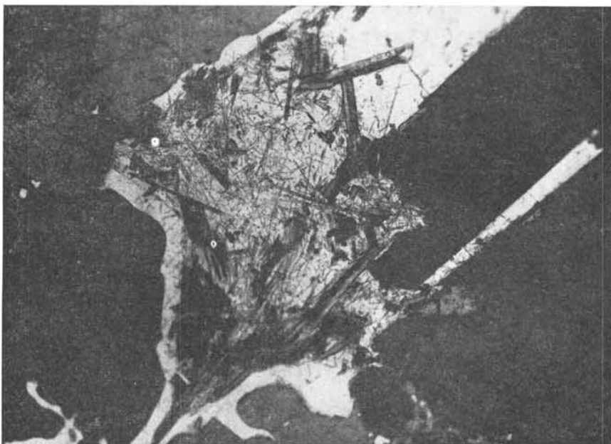
Fotomicrografia 5 — Mineral A, mostrando hábito alongado e geminação, imerso em cristais de cancrinita (branca). Lado esquerdo, parte inferior da foto, vê-se cancrinita (branca) formando-se a partir de nefelina (cinza médio e escuro). À direita da foto, cristais de feldspato alcalino (cinza) exibindo contornos regulares e, à esquerda, lado superior, cristais de egerina-augita. Nicóis cruzados. Aumento: 50 X.
